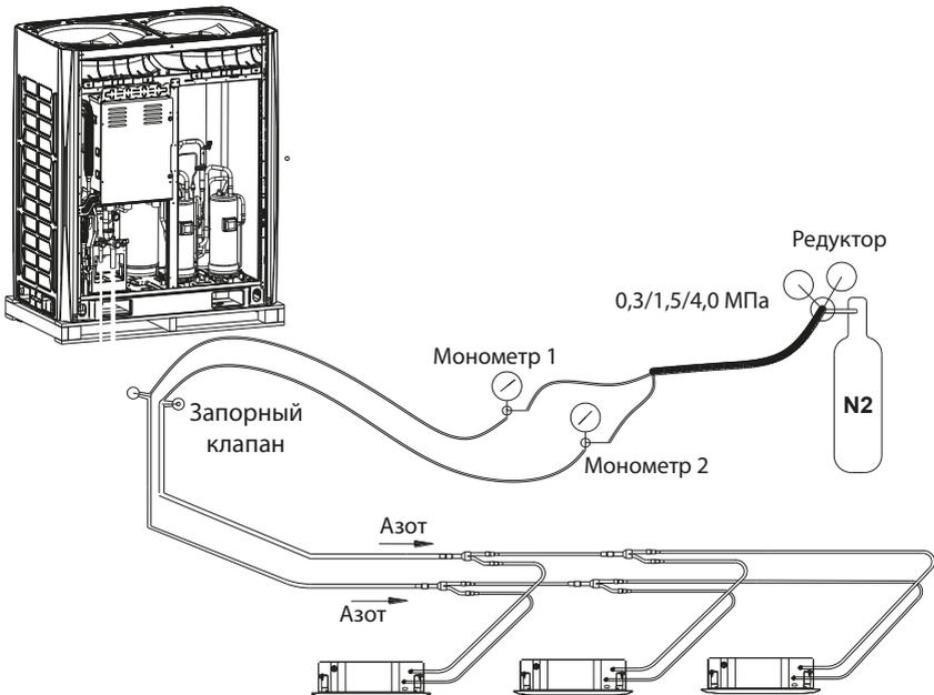
Если давление газа на манометре падает, нанесите мыльную пену (больше сосредоточьтесь на проверке места пайки, например, 1 ~ 8 как показано ниже), найдите место утечки и выполните повторную пайку.
