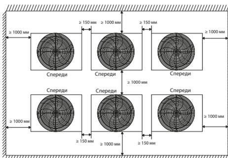
Если особые обстоятельства установки требуют размещения агрегата ближе к стене, чем указано на рисунках выше, следует установить выпускной канал (см. пункт «Монтаж воздухопроводов»). В зависимости от высоты прилегающих стен по отношению к высоте блоков может потребоваться воздуховод для обеспечения надлежащего отвода воздуха. В ситуации, изображенной на рисунке ниже, вертикальное сечение воздуховода должно быть высотой не менее  $H-h$ .
