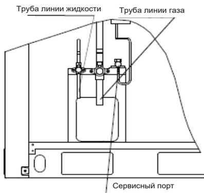
1. Соединения трубопровода хладагента расположены внутри наружного блока; поэтому, их отсоединяют в первую очередь. Потяните за трубку, чтобы отсоединить ее.
