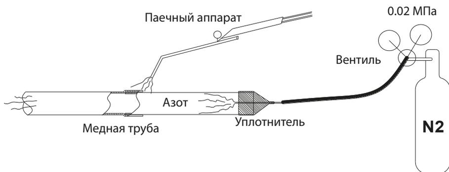
Пайку необходимо провести в среде инертного газа (азот), чтобы предотвратить образование слоя окисления ( $\text{Cu}_2\text{O}$ ) в медной трубе при пайке, иначе значительные слои окисления приведут к блокировке капиллярной трубки или расширительного клапана, ненормальной температуре нагнетания, плохой производительности охлаждения или нагрева.
