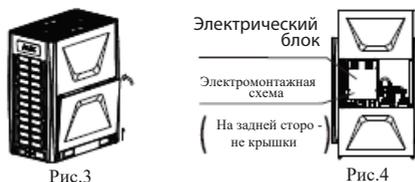
При первом демонтаже пластины 1 следует также удалить прокладку 2 из пенополиэтилена, расположенную в нижней части блока и распустиить винты 3. Надавте на панель или вставьте отвертку в зазор между панелями 4 и снимите аккуратно панель. Исключите вероятность соскальзывания панели, как показано на рисунке 1.
