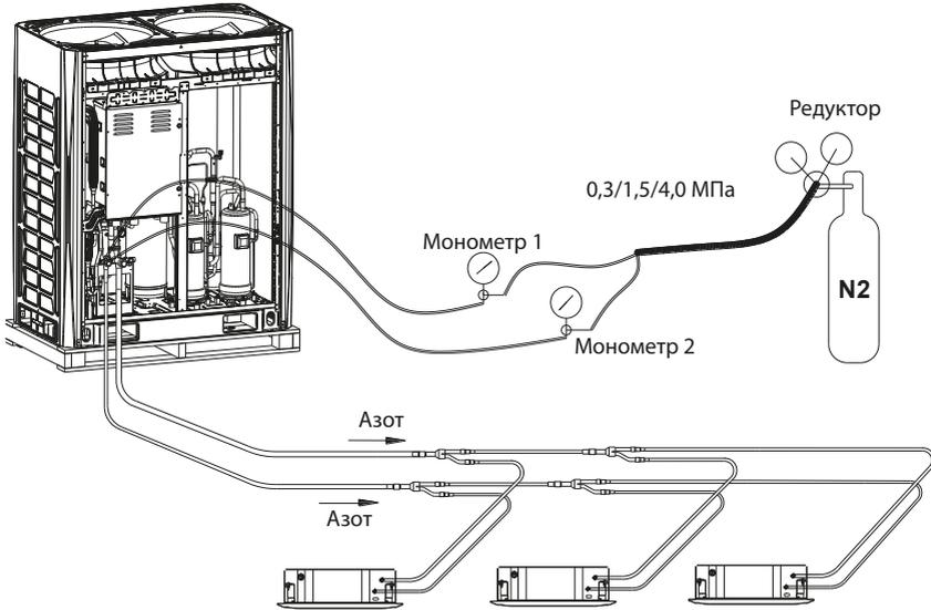
2. Режим опрессовки азотом: Подключение к магистральному трубопроводу для газа и жидкости
