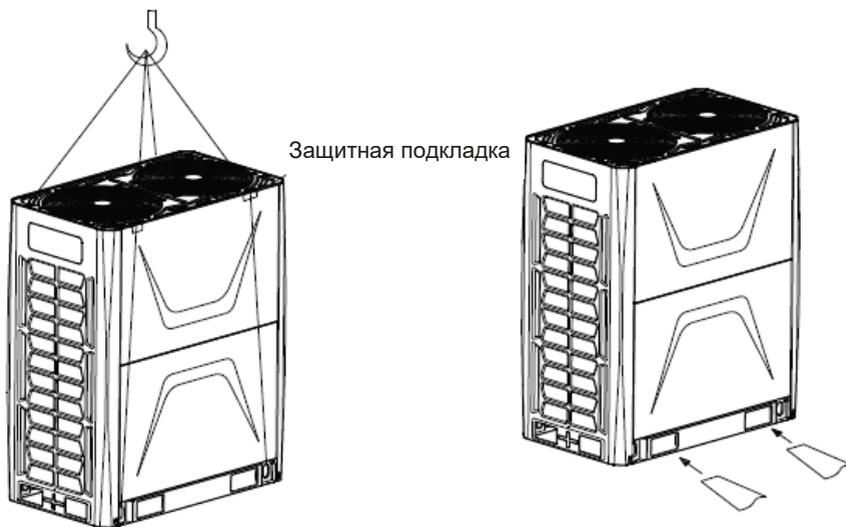
Используйте вилочные погрузчики для транспортировки кондиционера.
