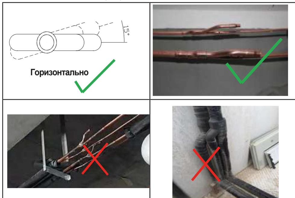
Для обеспечения сбалансированного распределения хладагента длина трубы между двумя разветвителями  $\geq 1000$  мм, длина прямой трубы после разветвителя  $\geq 500$  мм
